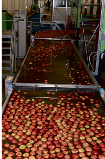
Das GeoSort-System erlaubt eine Sortierung von bis zu acht Früchten pro Sekunde
